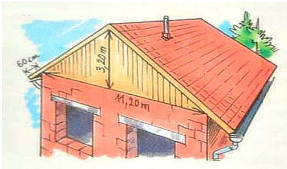
Ein Neubau ist 11,20 m breit. Der darüber liegende gleichschenklige Dachgiebel hat eine Höhe von 3,20 m. Die Dachbalken sollen 60 cm überstehen.
